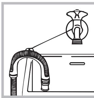
nebo ji uchyťte k okraji umývadla či vany a připevněte vodicí držák z příslušenství ke kohoutu (viz obrázek). Volný konec vypouštěcí hadice nesmí zůstat ponořený do vody.
